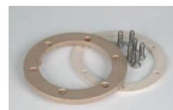
Jeu de bride, joint et vis, pour bonde de fond, Ø extérieur : 113 mm, Ø intérieur : 80 mm, Ø de l'entraxe des trous de vis : 92 mm. Pour utilisation en eau salée ou thermale au delà de 5g/l de sel ou 1g/l de chlore, le bronze est obligatoire.
