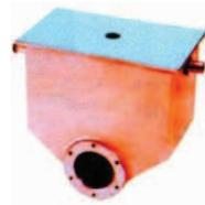
Régulateur mécanique de niveau d'eau, avec couvercle INOX 316L, profondeur 140 mm, adapté aux skimmers 1000020 et 1010020. Avec trous de vis sur flasque et pas de vis interne G2, pour fixation ou vissage de la coque de refoulement.
