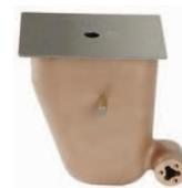
Régulateur mécanique de niveau d'eau, avec couvercle INOX 316L, profondeur 160 mm, largeur 90 mm, adapté aux skimmers 1252020 et 1262020. Avec trous de vis sur flasque et pas de vis interne G2, pour fixation ou vissage de la coque de refoulement.
