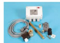
Régulateur électronique de niveau d'eau composé d'un boîtier d'alimentation, sonde de piscine, électrovanne, câble, etc... Le régulateur fonctionne avec une sonde, équipée d'un câble de 5 mètres de section 0,5 mm<sup>2</sup>. Avec cette section, il est possible d'employer un câble allant jusqu'à 100 m. La fréquence de relevé de la sonde est de 15 secondes, et elle est équipée d'un témoin lumineux à LED.
