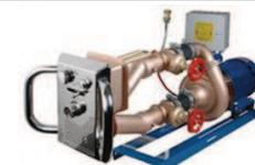
Système de nage à contre-courant JUNIOR, avec façade en inox 316L, pompe bronze 1.5 kW, 230/400 V, courant triphasé, entrée 2.0 kW. Débit de 700 litres par minute (42 m<sup>3</sup>/h) à 1 bar. (Fournie sans pièce à sceller, ni poignée). La photo et la figure ci-jointes montrent l'ensemble complet monté, avec ses pièces à sceller, poignée, et support de pompe.
