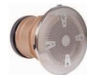
Crépine  $\varnothing$  485 mm en Inox 316L, avec boîtier d'aspiration DN 100 laiton rouge. Manchette et flasque de connexion en PVC. Conforme à la norme Sécurité Cheveux DIN EN 13451. Débits : 102,7 m<sup>3</sup>/h à 0,5m/s - 61,6 m<sup>3</sup>/h à 0,3m/s
