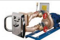
Système de nage à contre-courant JUNIOR, avec façade en inox 316L, pompe bronze 2.2 kW, 230/400 V, courant triphasé, entrée 2.8 kW / 4.8 ampères. Débit de 800 litres par minute (48 m<sup>3</sup>/h) à 1 bar (Fournie sans pièce à sceller, ni poignée). La photo et la figure ci-jointe montrent l'ensemble complet monté, avec ses pièces à sceller, poignée, et support de pompe.
