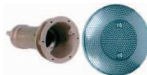
Crépine  $\varnothing$  200mm en Inox 316L, avec boîtier d'aspiration DN 65 laiton rouge. Filetage de raccordement G2½ interne. Conforme à la norme Sécurité Cheveux DIN EN 13451. Débits : 16,1 m<sup>3</sup>/h à 0,5m/s - 9,7 m<sup>3</sup>/h à 0,3m/s
