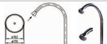
Canon à eau MIDI à jet étroit en cloche. Ensemble complet pour l'installation comprenant le canon en Inox 316L, les éléments d'installation, et une pompe bronze de puissance 1.1kW, 230/400V, 50Hz, triphasé.
