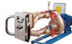
Système de nage à contre-courant JUNIOR, avec façade en inox 316L, pompe bronze 2.6 kW, 230/400 V, courant triphasé, entrée 3.4 kW / 5.8 ampères. Débit de 850 litres par minute (51 m<sup>3</sup>/h) à 1 bar. (Fournie sans pièce à sceller, ni poignée). La photo et la figure ci-jointes montrent l'ensemble complet monté, avec ses pièces à sceller, poignée, et support de pompe.
