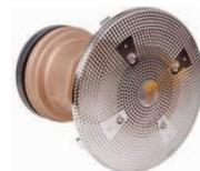
Crépine  $\varnothing$  350mm en Inox 316L, avec boîtier d'aspiration DN 80 laiton rouge. Manchette et flasque de connexion en PVC. Conforme à la norme Sécurité Cheveux DIN EN 13451. Débits : 52,7 m<sup>3</sup>/h à 0,5m/s - 31,6 m<sup>3</sup>/h à 0,3m/s
