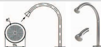
Canon à eau MIDI à jet large en cloche. Ensemble complet pour l'installation comprenant le canon en Inox 316L, les éléments d'installation, et une pompe bronze de puissance 1.1kW, 230/400V, 50Hz, triphasé.
