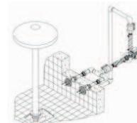
Ensembles complets de Champignons d'eau 2300 (ø 2300 mm), avec champignon en inox, crépine en inox 316L, vannes PVC à boule, pièces et pompe en bronze. Pompe laiton rouge, 5.5 kW, 400 / 690 V, 50 Hz, three-phase-current. Sur le plan le produit 8739020 correspond aux chiffres : 3, 4, 5, 6, 7, 8, 10, 11 et 12
