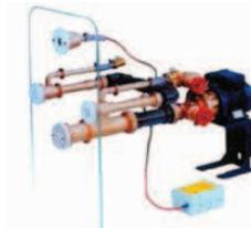
Système de massage de type STANDARD, kit complet (sauf pièces à sceller) pour bassin carrelé, avec pièces apparentes en Inox 316L comprenant 2 buses de massage, 1 crépine d'aspiration, 1 contacteur pneumatique, avec pompe bronze 0.5 kW 230V AC, et un boîtier de contrôle pneumatique.
