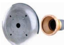
Crépine ø 485 mm en Inox 316L, avec boîtier d'aspiration DN 150 laiton rouge avec connexion PVC pour raccord et joints. Conforme à la norme Sécurité Cheveux DIN EN 13451. Débits : 102,7 m<sup>3</sup>/h à 0,5m/s - 61,6 m<sup>3</sup>/h à 0,3m/s
