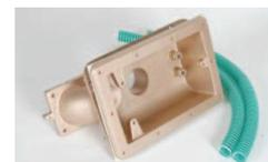
Pièce à sceller en laiton rouge pour nage à contre-courant JUNIOR-COMPACT, profondeur de montage 130mm, pour piscine préfabriquée (avec contre-bride et écrous), sorties des tuyaux d'aspiration et de refoulement avec flasques de raccordement.
