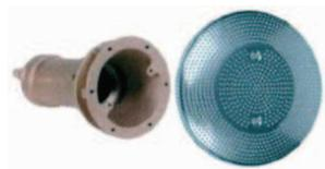
Crépine  $\varnothing$  350mm en Inox 316L, avec boîtier d'aspiration DN 65 laiton rouge. Filetage de raccordement G2½ interne. Conforme à la norme Sécurité Cheveux DIN EN 13451. Débits : 52,7 m<sup>3</sup>/h à 0,5m/s - 31,6 m<sup>3</sup>/h à 0,3m/s
