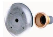
Crépine ø 485 mm en Inox 316L, avec boîtier d'aspiration DN 100 laiton rouge avec réduction et manchon PVC collé. Conforme à la norme Sécurité Cheveux DIN EN 13451. Débits : 80 m<sup>3</sup>/h à 0,5m/s - 50m<sup>3</sup>/h à 0,3m/s
