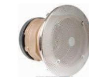
Crépine  $\varnothing$  485 mm en Inox 316L, avec boîtier d'aspiration DN 150 laiton rouge. Manchette et flasque de connexion en PVC. Conforme à la norme Sécurité Cheveux DIN EN 13451. Débits : 102,7 m<sup>3</sup>/h à 0,5m/s - 61,6 m<sup>3</sup>/h à 0,3m/s
