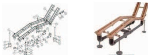
Pièces à sceller en laiton rouge pour 1 banquette à bulles, ensemble complet avec cache PVC, circuit de tubes, et gabarit de montage.
