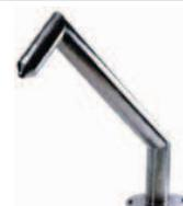
Canon à eau 60E (diamètre 60mm) à jet ponctuel. Ensemble complet pour l'installation comprenant le canon en Inox 316L, les éléments d'installation, et une pompe bronze de puissance 1,1kW, 230/400V, 50Hz, triphasé.
